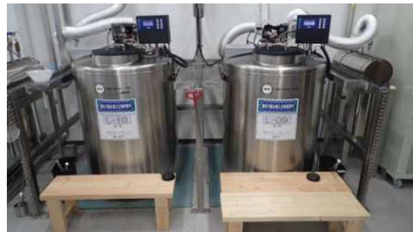
液相式MVE815 6台 2 mlチューブ 0.25 or 0.5 ml ストロー
