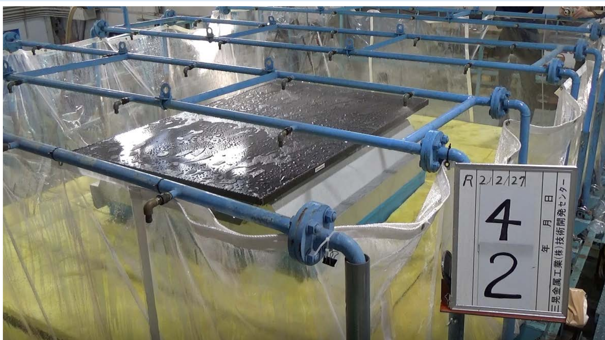
金属屋根散水試験の様子
